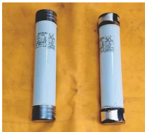
▼高圧限流ヒューズの正常品(左)と劣化品(右)
